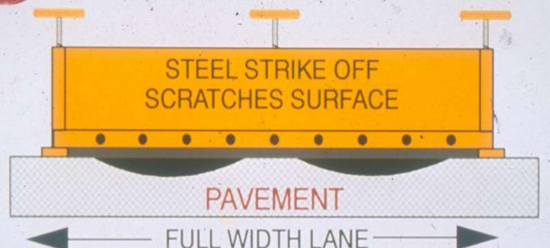
THE SCRATCH COAT IS GENERALLY 6" LESS THAN THE WIDTH OF THE LANE.
